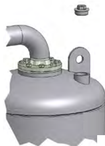
Dévisser le bouchon sur le manchon de remplissage
